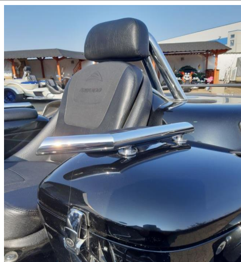
Edelstahl Rohr- Haltegriffe mit \varnothing 38 mm
