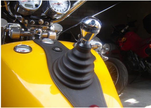
RF1 – Schaltgetriebe mit Manschettenhalter
